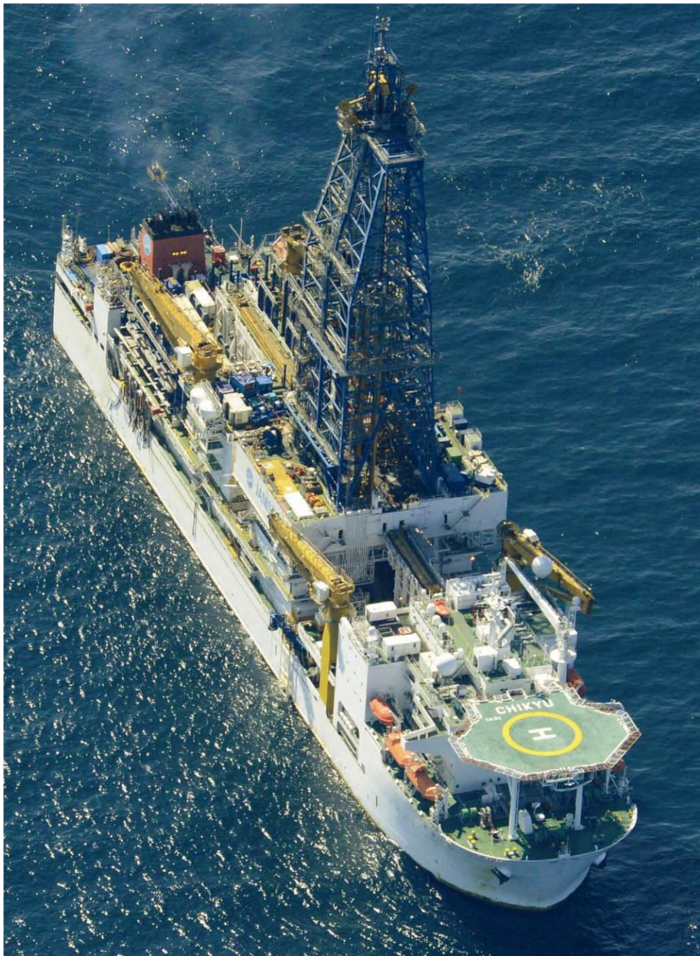
2013年3月12日，日本“地球”号深海勘探船在日本爱知县附近海域作业，通过降低地层压力将甲烷水合物中的甲烷气体与水分离提取，即成功分离可燃冰。
